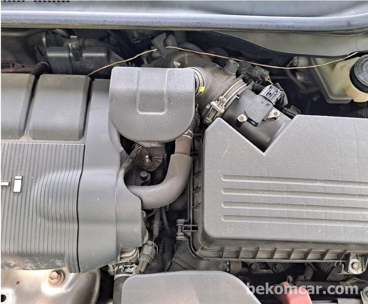
装回发动机设计盖。只需将盖子与每个角落相匹配，并与索环相匹配。轻轻推动设计盖板使其稳固就位。然后，先将电池与正极接线柱连接，然后再连接负极接线柱。-
