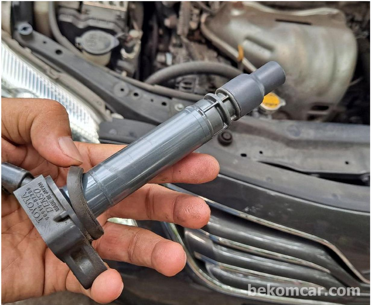
轻轻拉下线圈包。有四个线圈包。只需扭动一下即可拉下线圈包。 -
