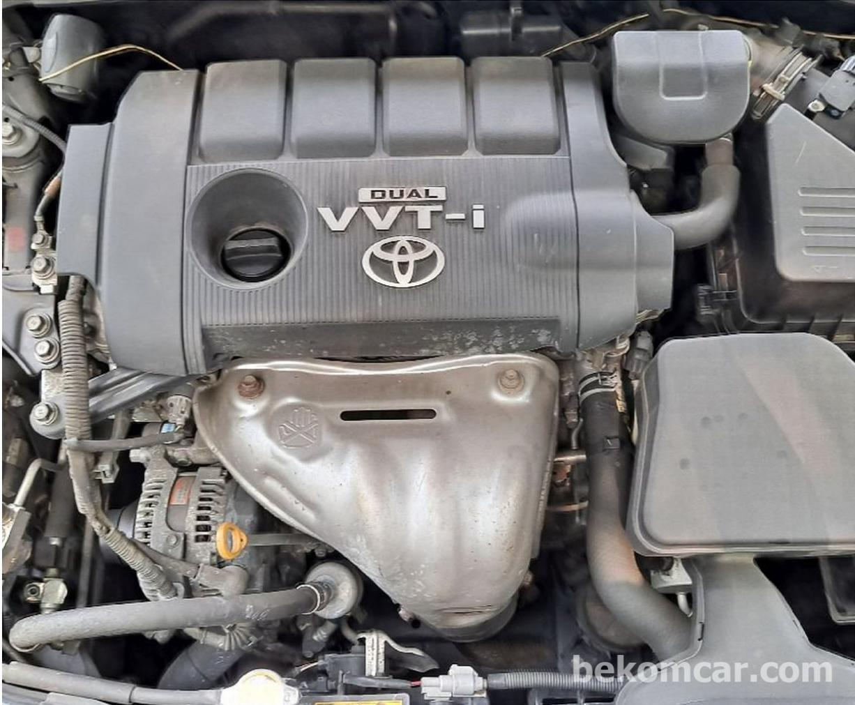
有三个固定发动机罩的垫圈。只需轻轻拉下盖子。 -
