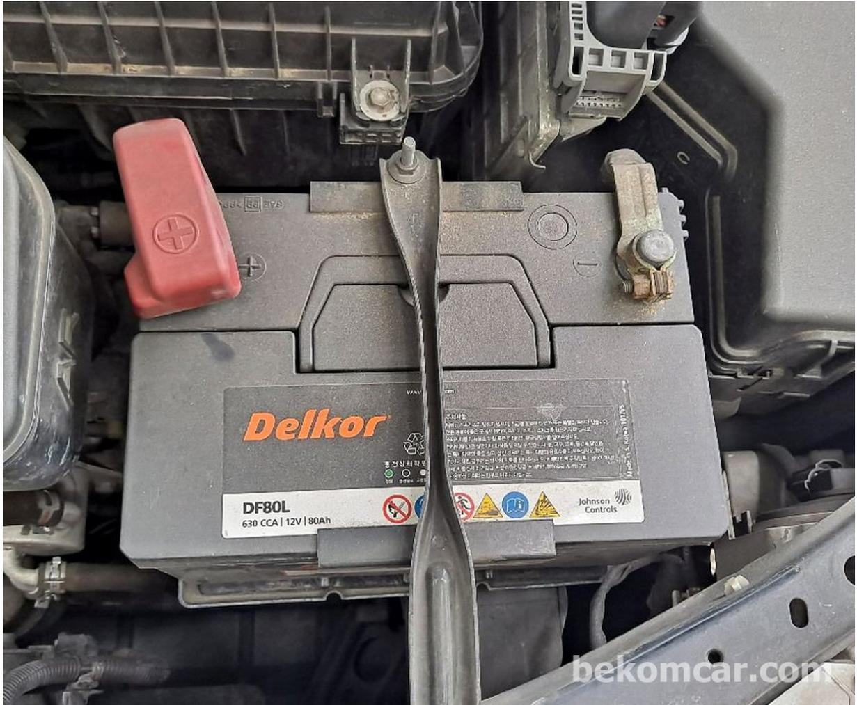
为安全起见，请先拆下电池负极连接器，然后再拆下正极连接器。使用 10 毫米扳手。 -
