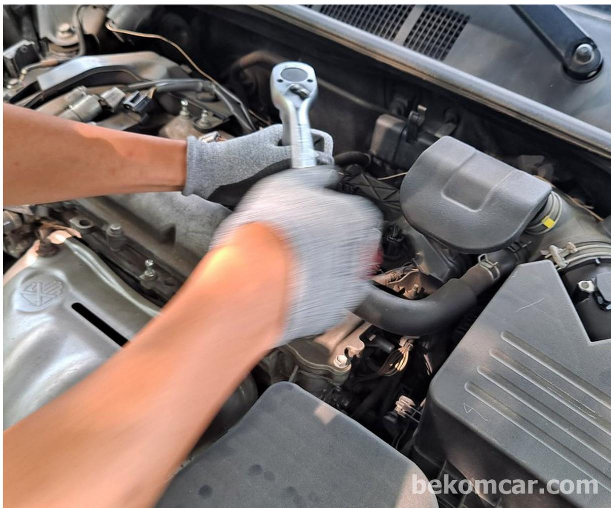
取下线圈组后取下火花塞。使用带 3/8" 或 1/2" 棘轮的 16 毫米火花塞插座。 -
