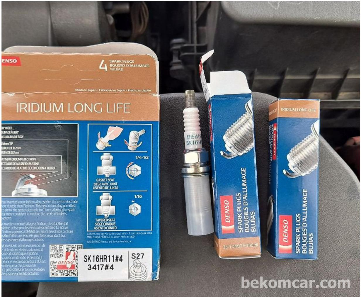
拆下所有火花塞后，准备好新的火花塞进行安装。-
