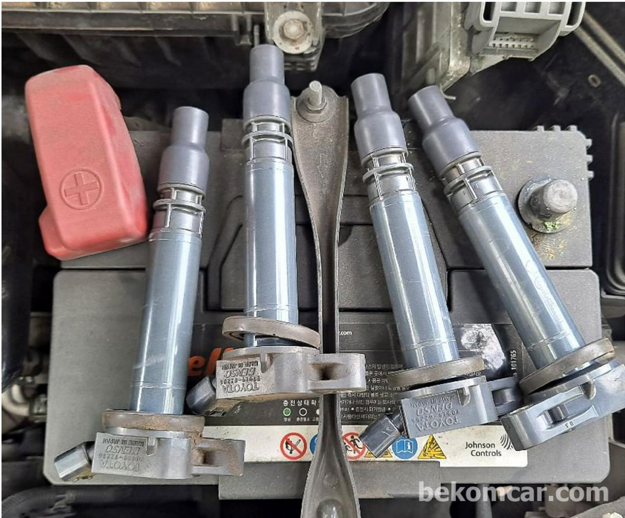
取下所有四个线圈包，如果有任何污染物，请目视检查线圈。 -
