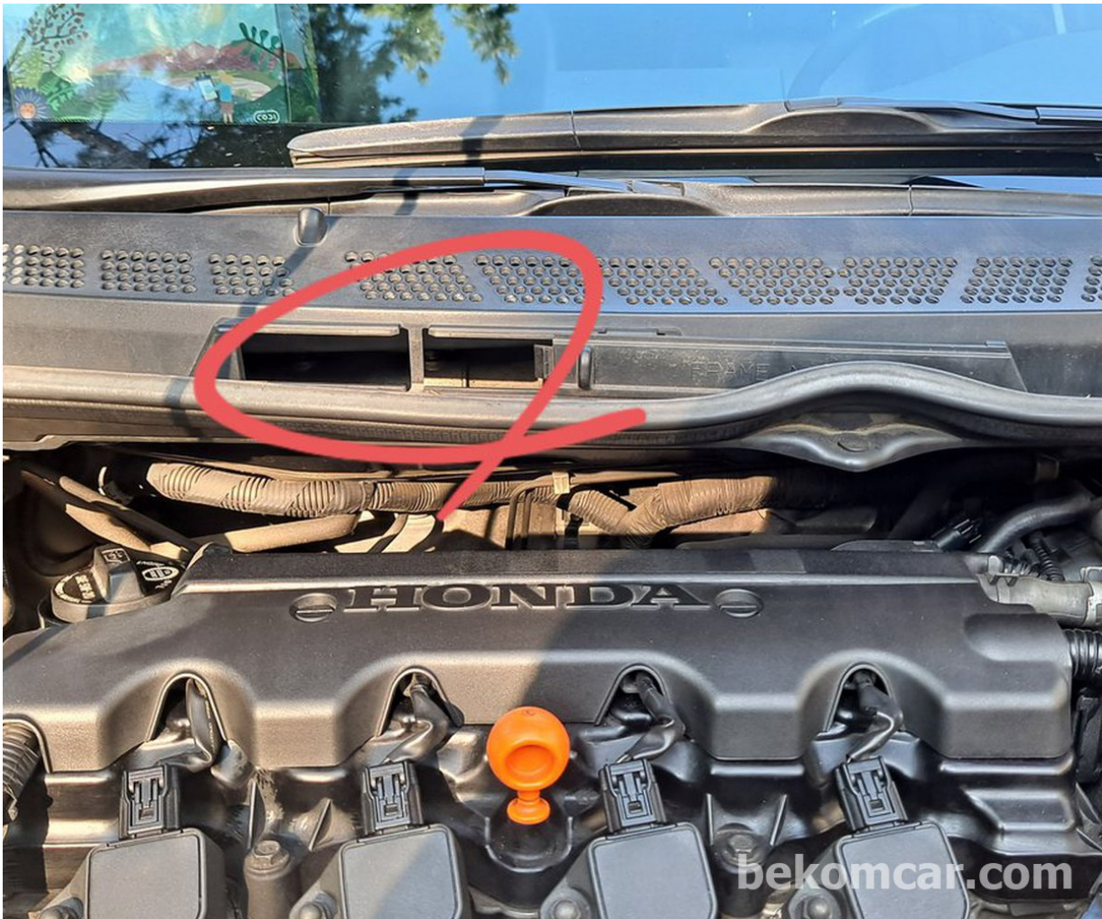
发动机室整流罩盖区域也标有VIN。 -
