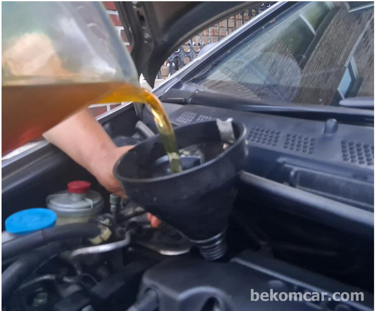
使用漏斗注入新的发动机油-
