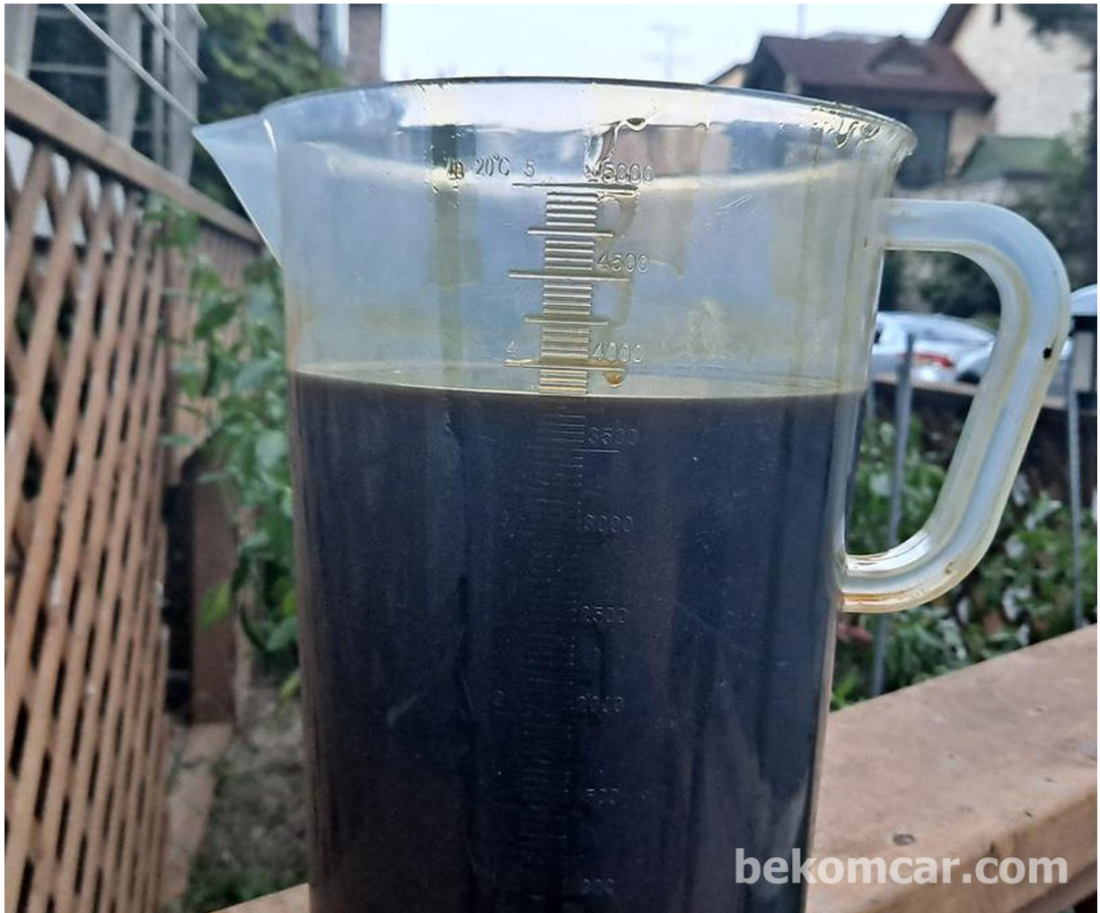
测量排出的发动机油-
