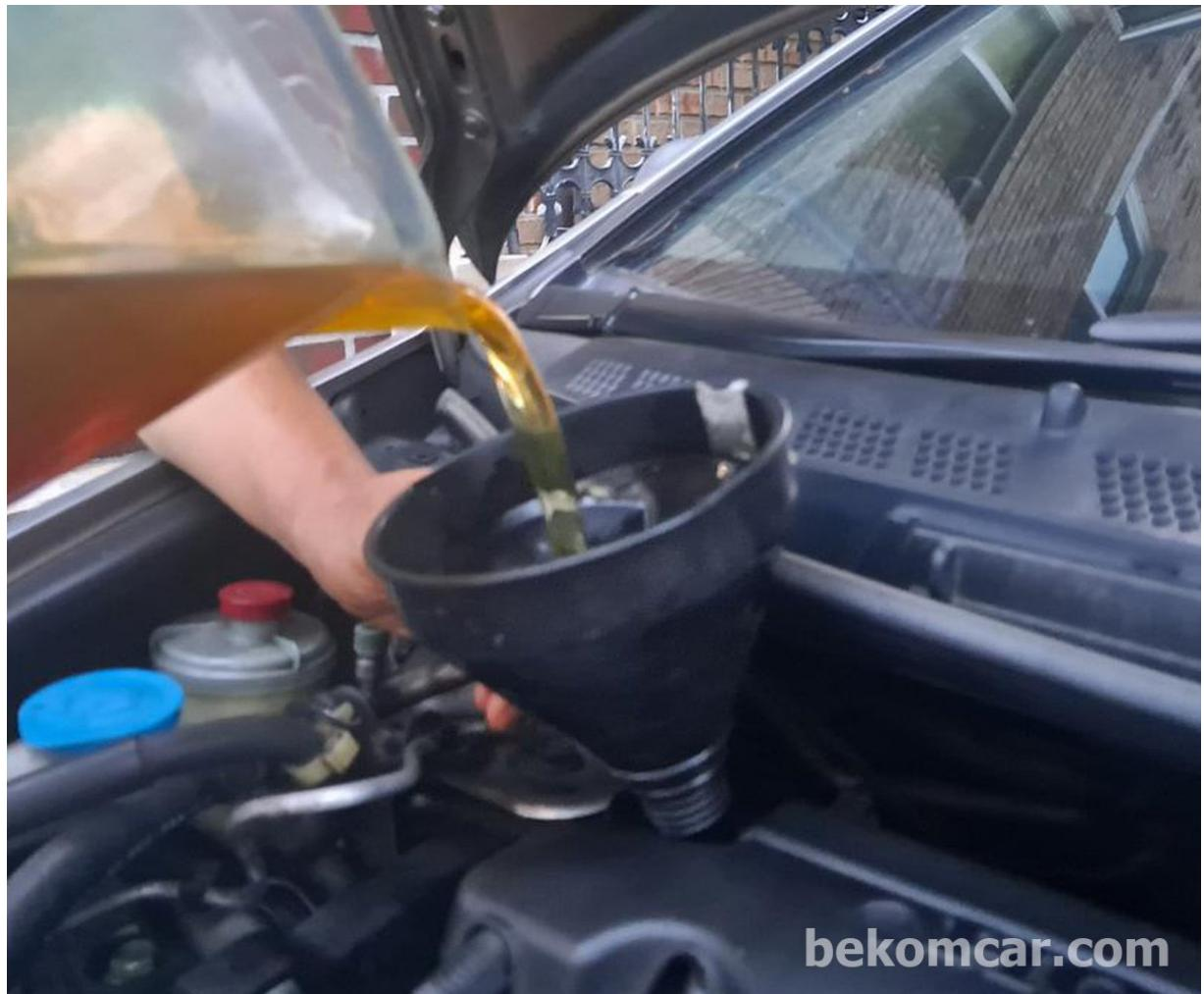
使用漏斗注入新的发动机油-
