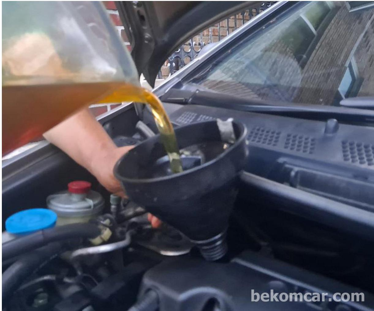
本田手册要求您每行驶 20,000 公里更换发动机机油滤清器和空气滤清器。运用常识，检查空气过滤器并适当更换。另外，尽量使用正品本田发动机机油滤清器。此过程仅适用于发动机机油，不包括更换发动机机油滤清器或空气滤清器。
