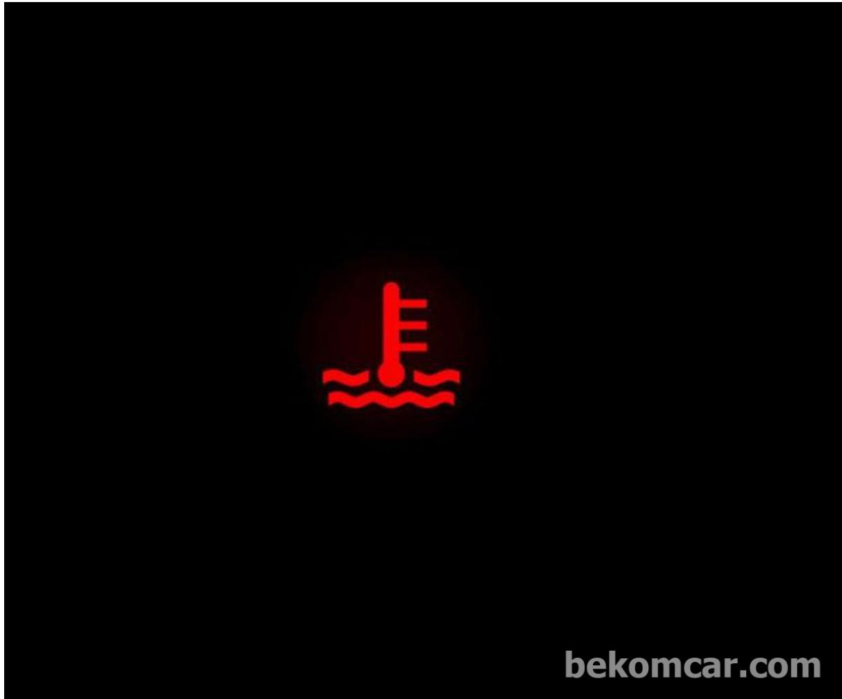
您的发动机由冷却液冷却。但出于某些原因，如果发动机温度不受控制并超出预设范围，则会出现高温警告灯。
