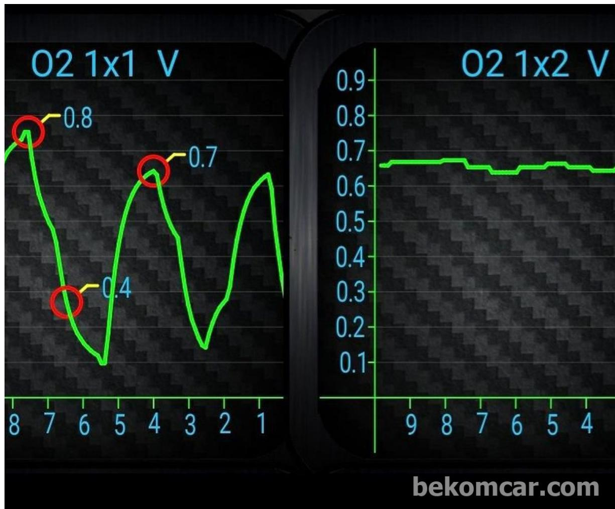
산소센서1의 역할은 배기가스내 산소량을 측정하여, 공기와 연료비율 계산에 사용하는 것입니다. 산소센서2는 측매가 정상인지를 판단하는 역할을 합니다. 산소센서1은 물결모양의 파형을, 산소센서2는 지평선처럼 1자로 되어야 정상입니다.-
