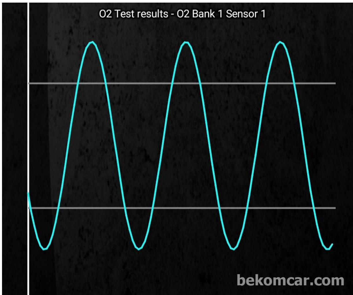
Torque pro의 그래프는 업스트림 O2 센서가 정상인지를 보여주고 있다. Y축과 X축에 표시되는 단위는 없지만 일정한 간격으로 위아래로 사인파가 발생하고 있어 O2 센서가 잘 작동하고 있음을 알 수 있다. O2 센서의 상태가 좋지 않으면 그래프가 침부된 그래프처럼 사인파로 표시되지 않는다.
