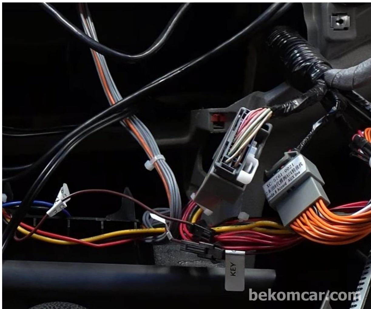
Steering Handel Control은 네비게이션 모델과 아닌 모델로 나누어서 하네스 작업을 한다. KEY 라벨에 Controls navigation.. 과 controls car 처럼 네비게이션 모델과 아닌 모델로 구분하여 하네스를 연결해야 한다. Photo credit: <https://www.youtube.com/watch?v=ElDtnz3bbJI>
